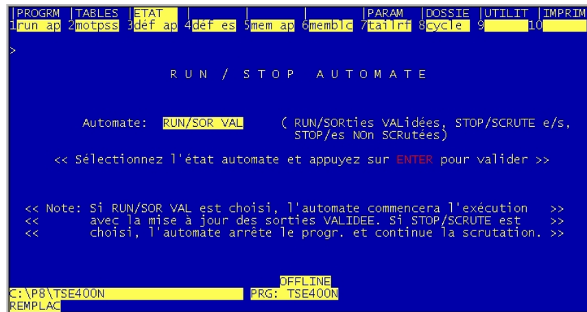
Figura 6.4. Arranque o Parada Autómata.
