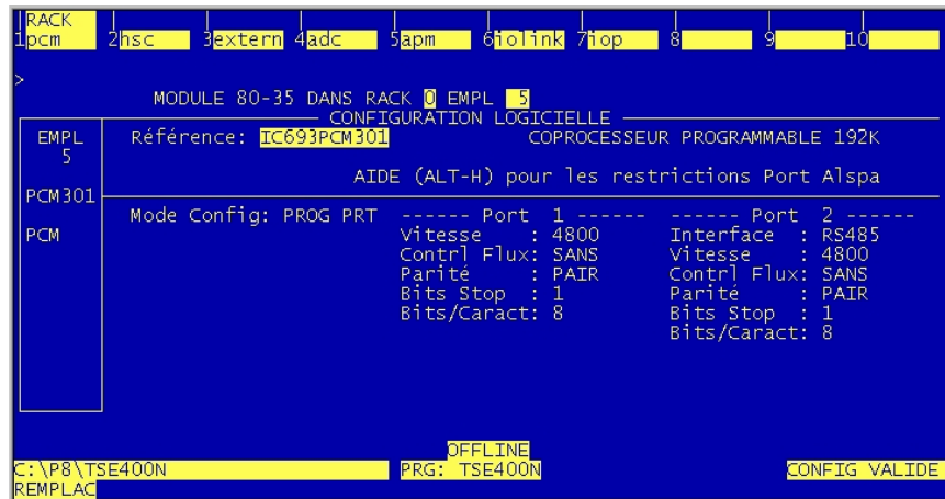
Figure 6.20. Ejemplo de características del Módulo de Comunicación PCM301.
