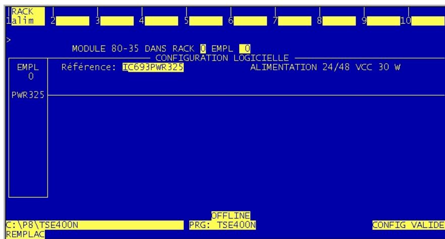
Figura 6.19. Ejemplo de características del Módulo de Alimentación PWR325.
