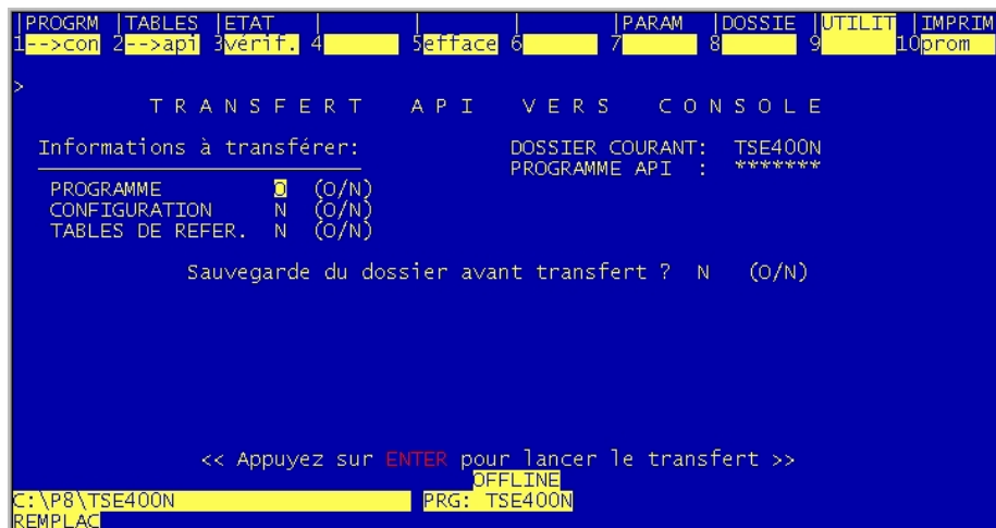
Figura 6.13. Transferencia de información desde PLC a PC.
